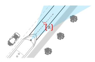
3. À l'arrêt ou à faible vitesse et lorsque des objets très proches se trouvent devant le véhicule, le calcul de la TTC ne fournit pas d'informations significatives. Par conséquent, le rayon de déplacement d'un objet par rapport à son propre véhicule est cartographié. Si ces rayons commencent à se chevaucher, une information système correspondante est générée.
