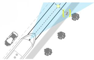
2. Si le temps total calculé jusqu'à la collision atteint la valeur seuil configurée, un avertissement est envoyé au conducteur. Le calcul du temps jusqu'à la collision avec une valeur de 1,8 s (valeur réglable) génère un signal d'information supplémentaire.
