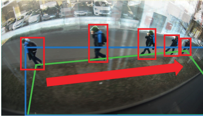
Abbildung 8: Zeitlich überlagerte Bilder einer unkritischen Situation: Das Fahrzeug überholt eine Person, die sich im Abdeckungsbereich befindet. Die Relativbewegung der Person führt von der Fahrzeugfront weg.
