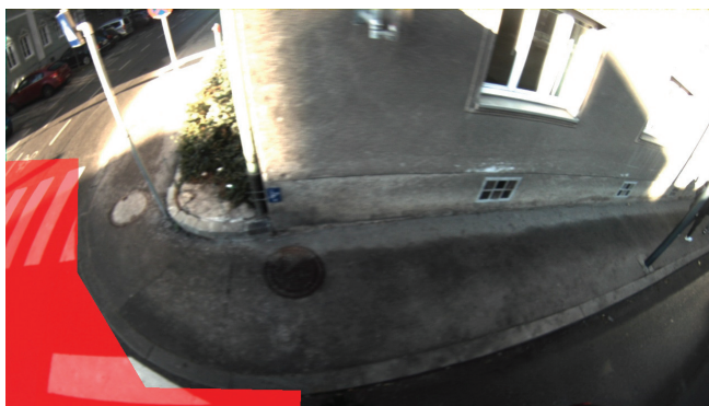
Abbildung 10: Kritischer Bereich (rot), der während des Abbiegevorgangs eine Rolle spielt.
