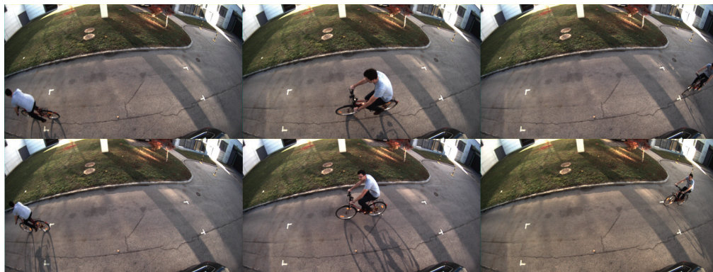
Abbildung 11: Kontrolliert hergestellte kritische Situationen ähnlich KBA Anforderungen: Ein Radfahrer mit unterschiedlichen Geschwindigkeiten und Abständen am Abbiegeassistenten vorbei.
